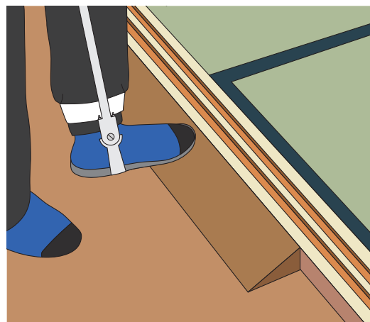
室内用スロープ 装具でスロープ上に乗るバランスを崩さないか注意
